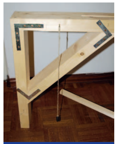
Fig. 11. Chorobates (detail schietlood).
