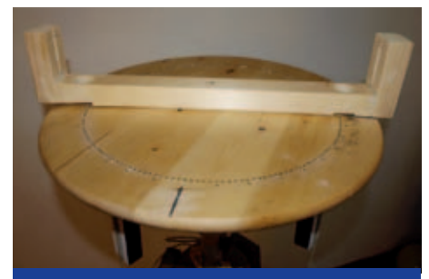
Fig. 7. Randverdeling en vizier van deze reconstructie.
