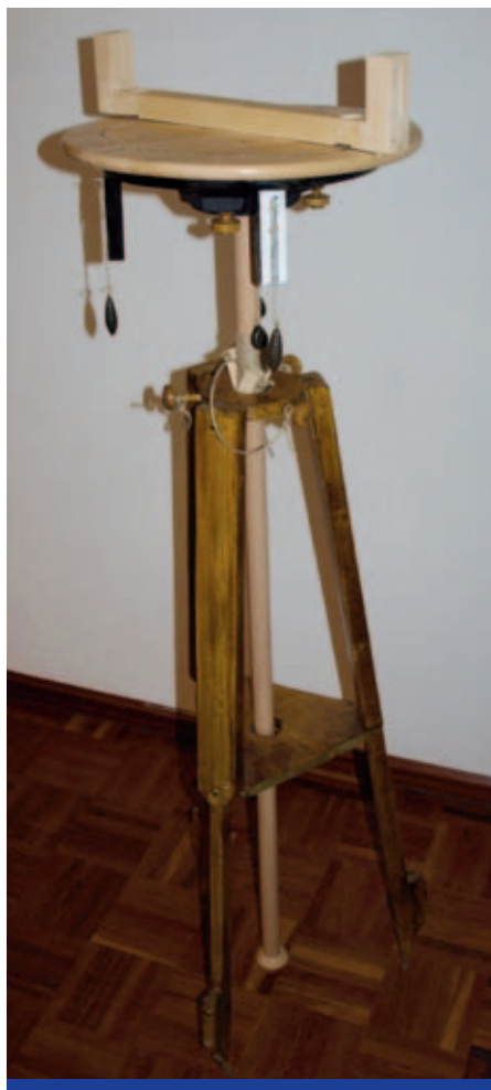
Fig. 6. Eigen reconstructie van een Dioptra.
